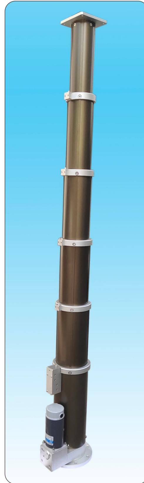
MHDX系列多节螺杆重载升降杆是温州鹿城天和自动化元件厂自主研发的具有自主知识产权的一款电动升降杆, 其载重、可靠性都很优秀。该产品由多节螺杆和硬质铝合金圆管彼此相互嵌套组成, 为达到更好的方向准确性, 导向缸都采用的是四条导向筋。本系列具有升降过程平稳、可靠、载重量大的特点, 具有行程内任意位置自锁功能。
