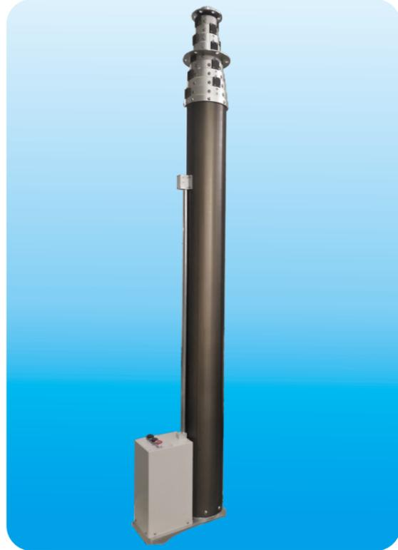
SPM系列电动升降杆是温州鹿城天和自动化元件厂自主研发的一款轻载高精度电动升降杆，它是由螺杆和连接套上锁扣机构实现升降杆逐节升降，而且在任意高度带有自锁功能。通过控制系统和感应器对电机转动圈数的控制实现升降杆升降高度的高精度控制，摒弃了气动升降杆和钢丝绳拉动式升降杆对升降高度的控制不精确、误差大缺点。为了获得更好方向稳定性，本厂选用四条筋导向缸。控制方式有线控和遥控，在无电的情况下可以通过手动操作实现升降。
